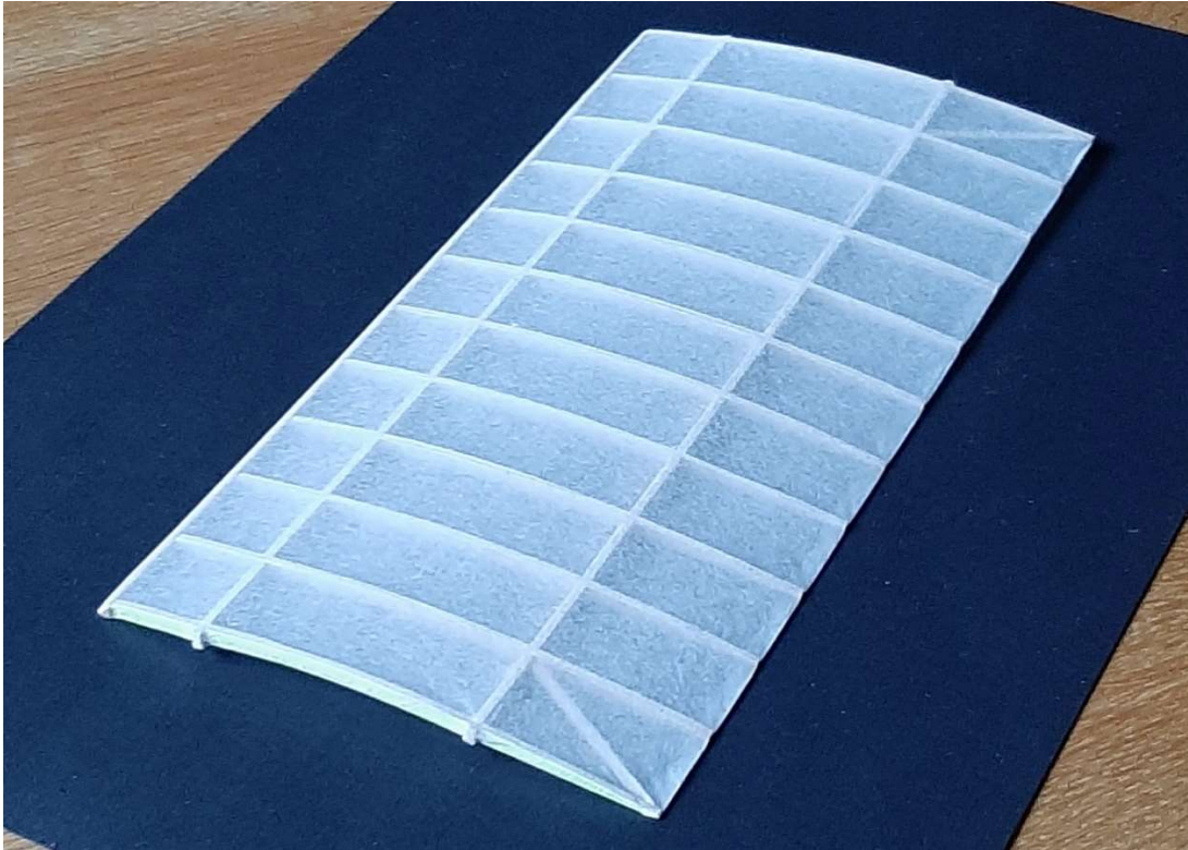
Figur 8. Den färdiga vingpanelen. Bakre delen av ytterspryglarna har stagats för att motstå pappersspänningen bättre.
