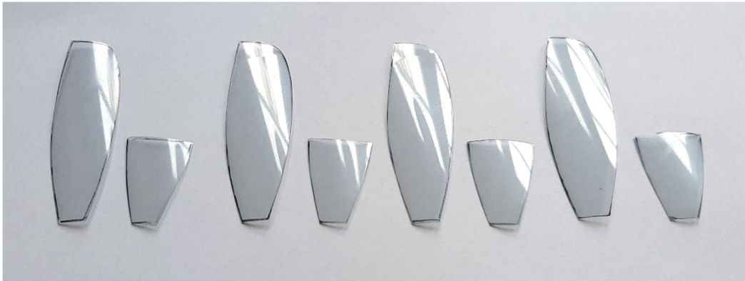
Figur 19. Blad till propellern i figur 1 med tillhörande förstyvningar. Blänket i delarna ger en indikation om deras lutning i förhållande till flaskans axel.
