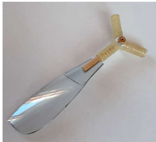
Figur 23. Nav av formpressade halvor med ett av propellerbladen.
