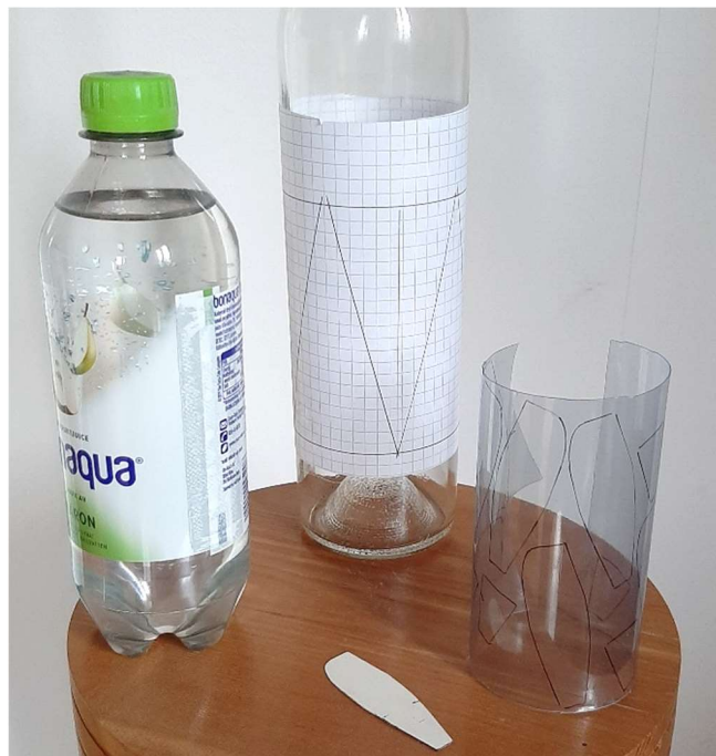
Figur 18. PET-flaska, uppklippt PET-flaska med en uppsättning blad markerade och även en glasflaska med 15-graders markeringar som hjälp för uppritandet. PET-svepet viras runt den markerade flaskan, mallen läggs utanpå i markeringarnas riktning, sedan är det bara att rita, och klippa.
