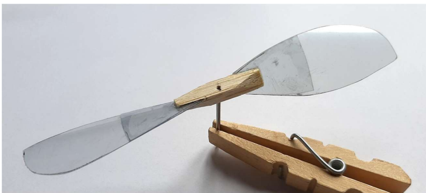
Figur 20. Ämne till vanlig tvåbladig högergående propeller med nav av balsalist.
