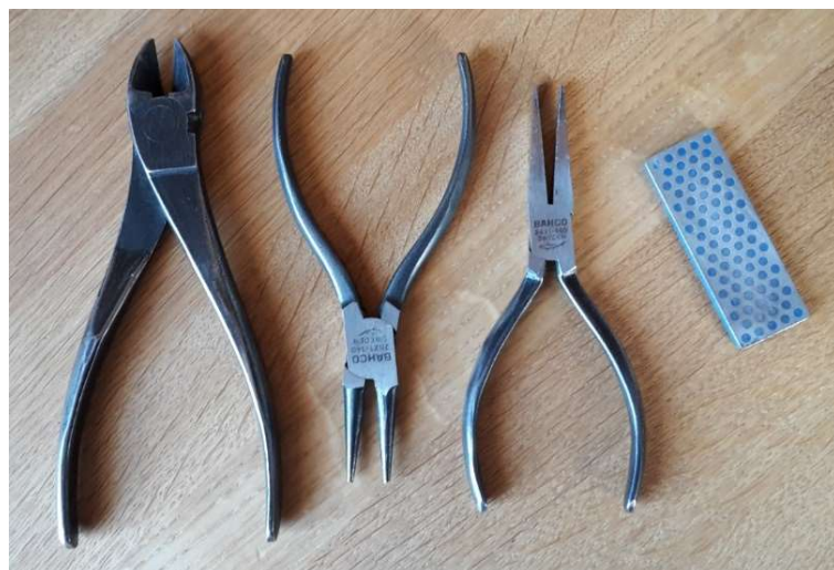
Figur 2. Lämpliga verktyg, kraftig avbitare, rundnosad böjtång, flacktång och diamantbryne.
