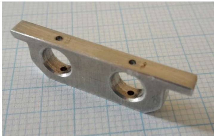
Figur 7. Axellagring med två 1,0 mm genomgående hål för axlarna, och två större lätthål.
