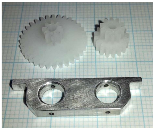
Figur 6. Den färdiga axellagringen med kugghjul.
