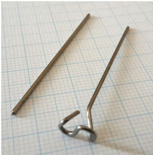
Figur 8. Axlarna, S-krok på motoraxeln.
